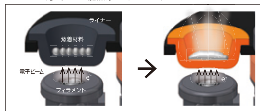
ボンバード方式による加熱原理 (イメージ図)
